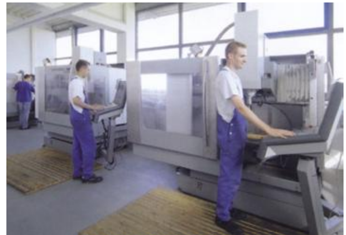
Ultrasonic-Bearbeitungsmaschinen: CNC-Technik MACK ist weltweit eines von wenigen Unternehmen, dass über Ultraschalltechnik Werkstoffe wie Glas und Keramik zerspanen kann
